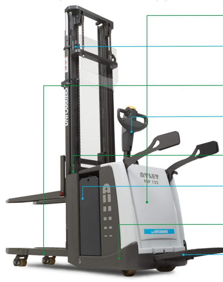
Мачта ProVision со смещенным относительно центра подъемным цилиндром обеспечивает лучшую видимость вил.
